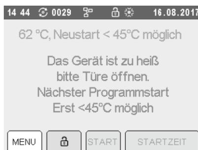
Abbildung 24 - Neustart erst bei Temp. <45°C möglich
