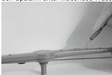
Abbildung 28 - Reinigung der Düsen des Spülarm
